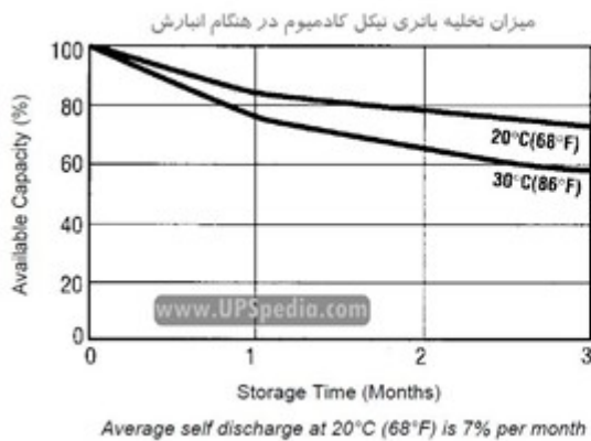
شکل ۴: مقایسه میزان افت شارژ باتریهای نیکل کادمیم و سرب اسیدی هنگام انبارش
